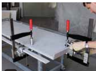
2 Schürze fixieren und mit Schwenkstück gegen die Platte schwenken
