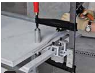
4 Kleber auf Gehrungskante auftragen
