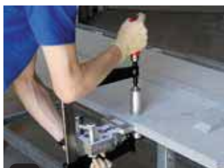
1 Klebevorrichtung mit Hilfe der Schraubzwinge anbringen und fixieren
